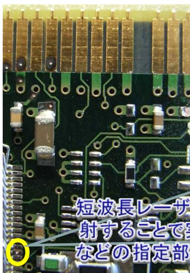
短波長レーザーを制御照射することで実装基板などの指定部位を分析
