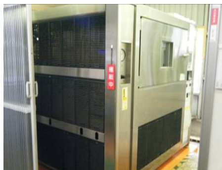
酢酸酸性腐食促進試験装置 (SWAAT試験) (出典:スガ試験機株式会社HP)
