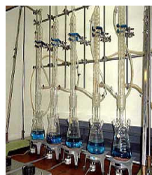
シュトラウス試験状況
