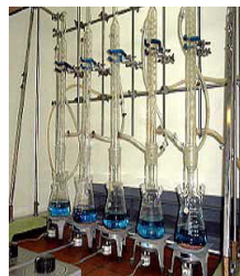
シュトラウス試験状況
