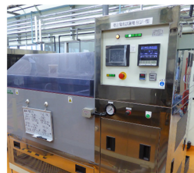
酸性サイクル腐食試験機 (SWAAT、人工酸性雨等)
