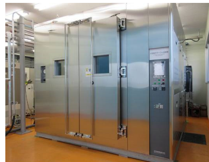
超大型サイクル腐食試験機 (2号機、-20°Cも可能)
