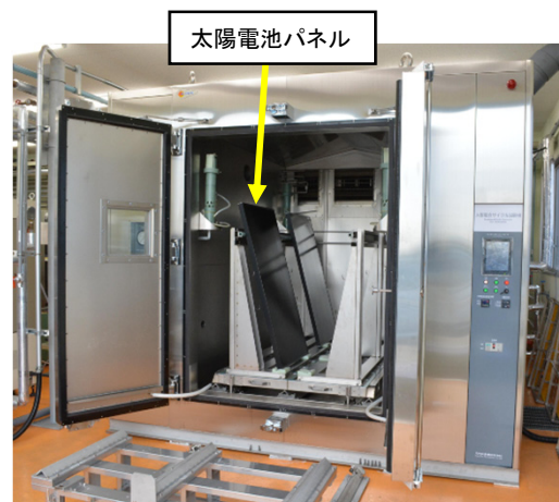
大型太陽電池モジュールの複合サイクル腐食試験機への取り付け例
