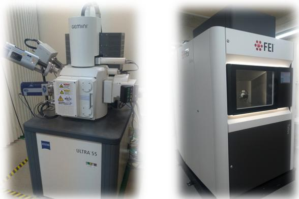
図2 対応装置の例(左:ULV-SEM、右:高感度分析STEM)
