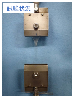
ロードセル: 50 N, 500 N, 20 kN 変位: 0 mm-180 mm
