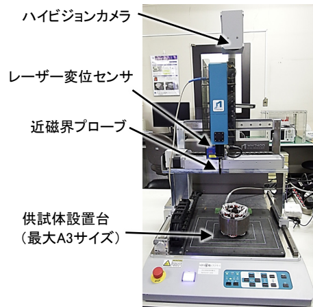
部分放電可視化システムの外観
