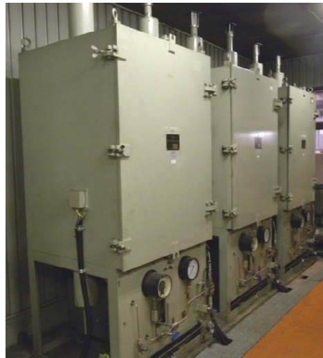
図1 内圧クリープ試験機の外観
