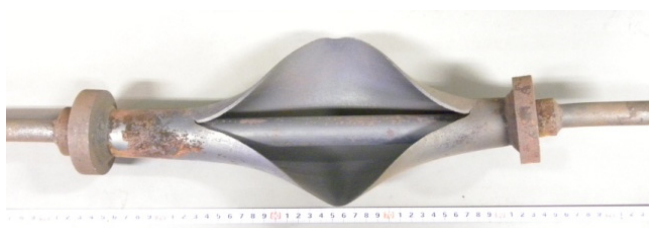
図4 内圧クリープ試験の試験体(試験後:破断後)
