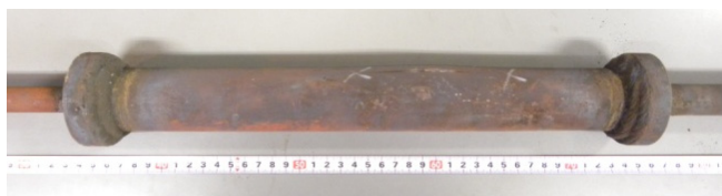
図3 内圧クリープ試験の試験体(試験前)
