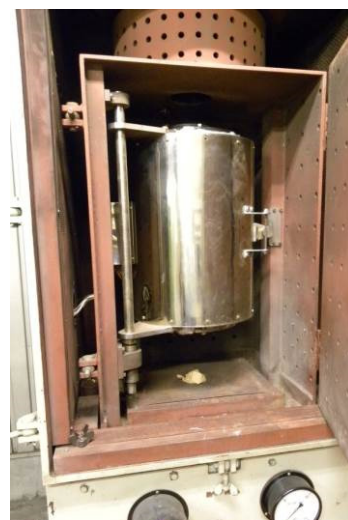
図2 試験機内部(加熱炉)
