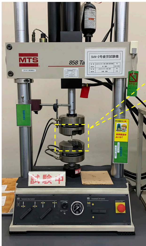
試験状況 (5kN疲労試験機)
