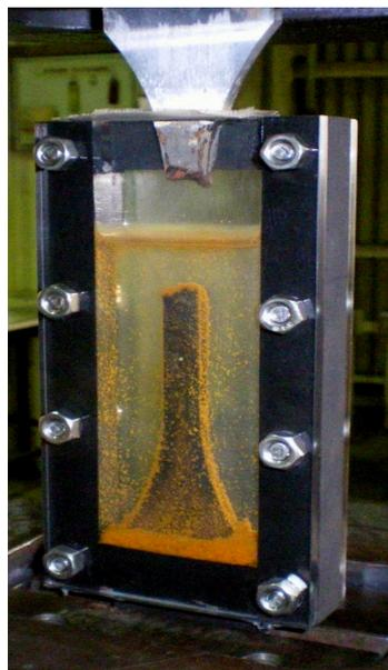
平板試験片を用いた軸力疲労試験
