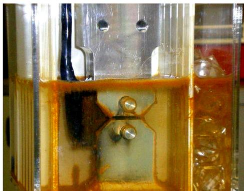
CT試験片を用いた疲労き裂進展試験
