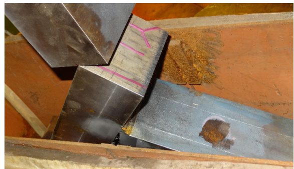
写真6 破面試験状況(厚板)
