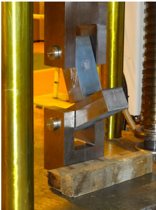
写真5 破面試験状況(厚板、引張)
