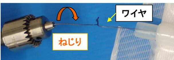
手元端の回転により、破壊までの回転数を測定
