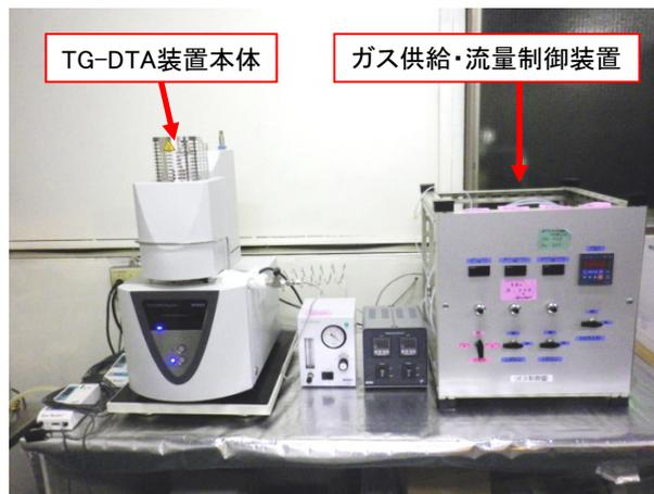
図1 TG-DTA試験装置外観
