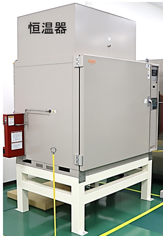
暴露試験装置(恒温器/小型圧力容器) ・温度:MAX.300℃ ・圧力:1MPa未満 ・容器サイズ:Φ259mm×高さ185mm
