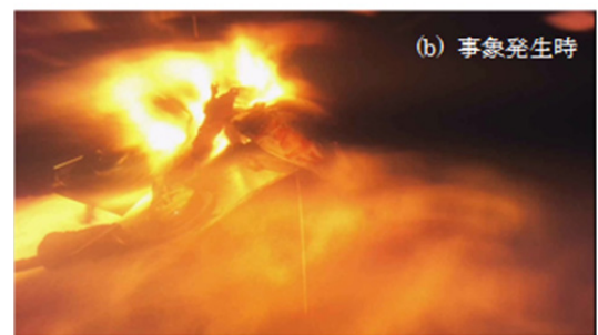
過充電試験時の電池セル観察の一例
