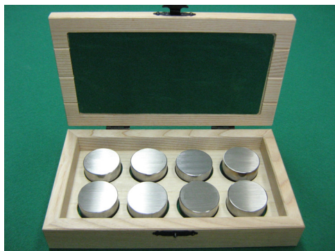
図1. ステンレス鋼標準試料(機器分析用)
