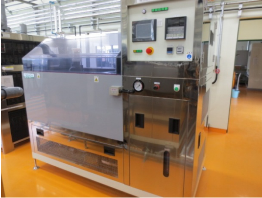
酸性溶液可能な複合サイクル試験機
