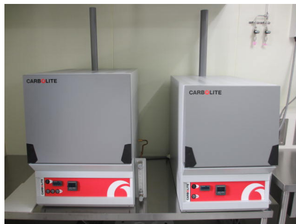
クリーンルーム内に設置した灰化炉 右:大容量タイプ 左:耐食性タイプ
