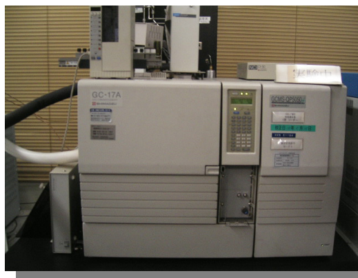
GC/MSIにてTVOCを、HPLCにてホルムアルデヒドを分析
