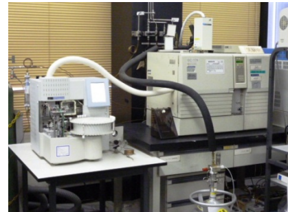
GC/MSIにて有機塩素系化学物質を分析
