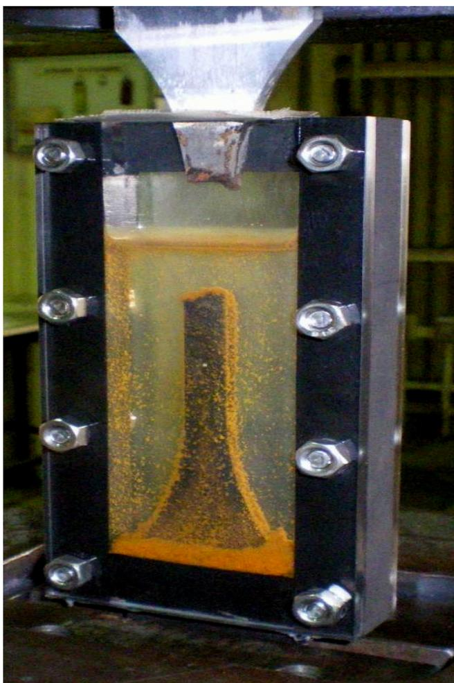
平板試験片を用いた軸力疲労試験
