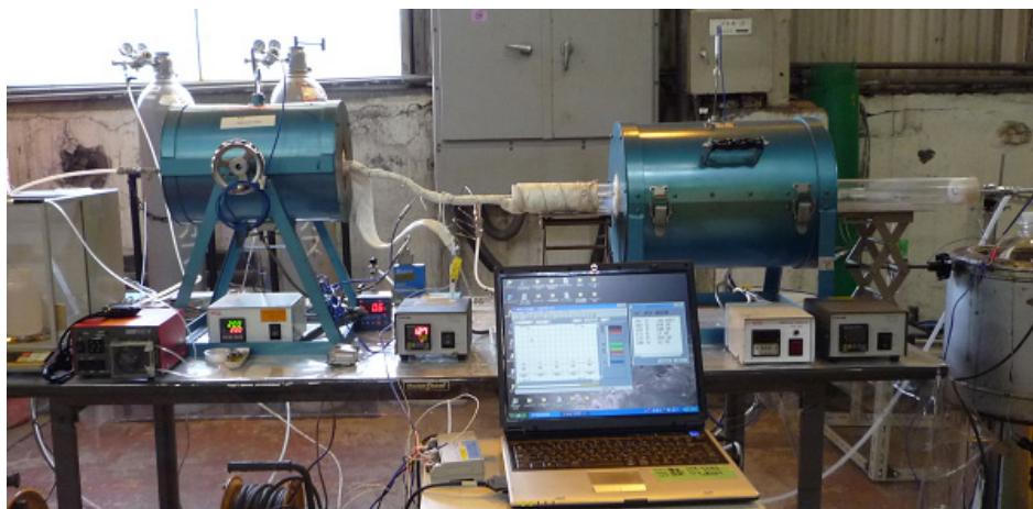
各種雰囲気に対応する試験装置例 左側:加湿調整装置・雰囲気ガス調整装置 右側:試験部(加熱装置)
