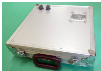
図-1 小型の光ファイバー温度計 (光ファイバー長さ: 10メートル)
