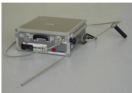
図1 光ファイバー温度計の外観
