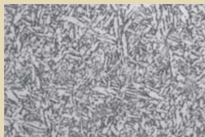
(1) 高靱性の微細フェライト溶接金属組織(酸化物:適量)
