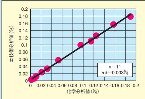
図 本技術による炭素鋼中のCの正確さ
