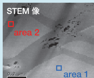
図1 大気非暴露下でのアルゴンイオンミリング加工により断面加工したSi負極のSEM像
