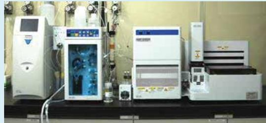
写真1 自動燃焼-イオンクロマトグラフ分析装置
