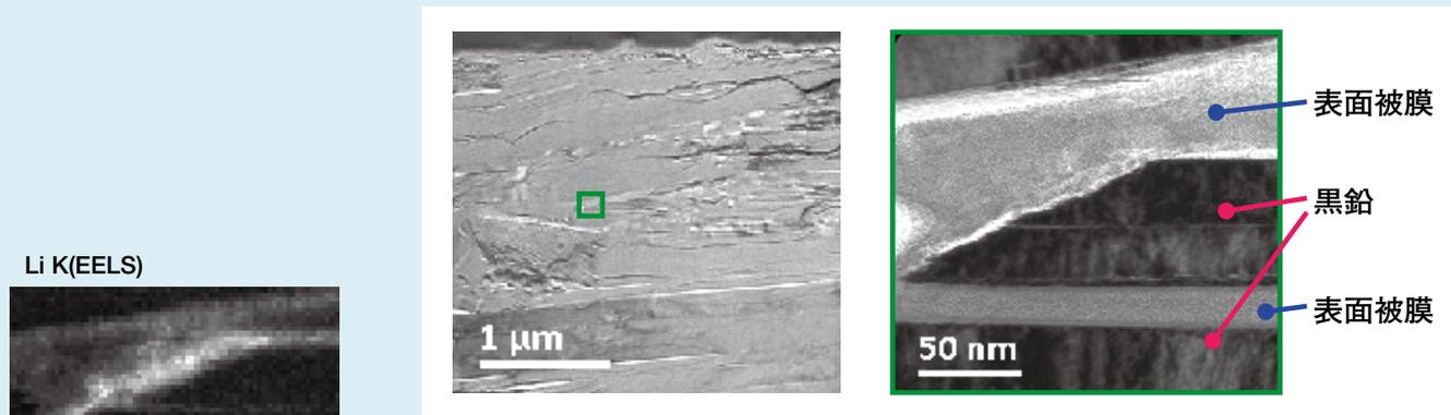
図1 黒鉛負極のTEM像 (右図は左図中の緑枠領域の拡大)
