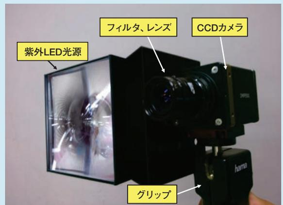
写真 漏洩油のポータブル検出装置
