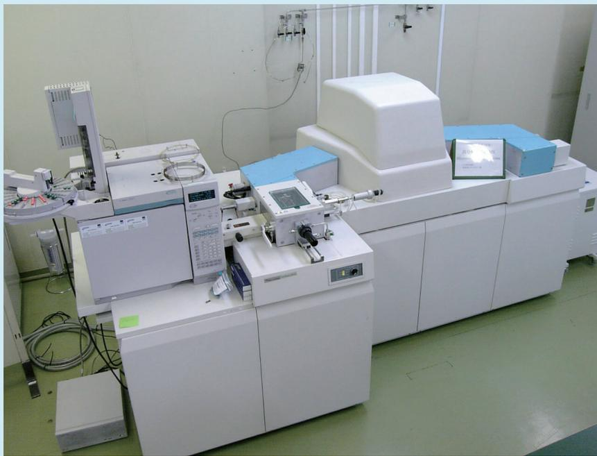
写真1 高分解能ガスクロマトグラフ質量分析装置
