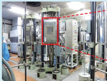
写真1 樹脂用クリープ試験機 (9台)
