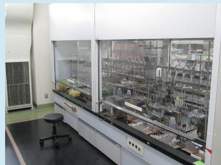
写真2 PCB分析前処理設備
