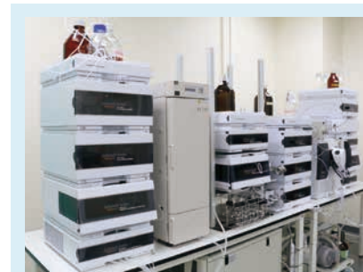
写真1 分取LC/MS-オンラインSPEシステム
