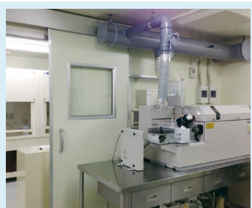
写真 クリーンルーム内に設置したICP質量分析装置
