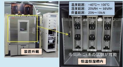
図2 電気式温湿度制御試験機
