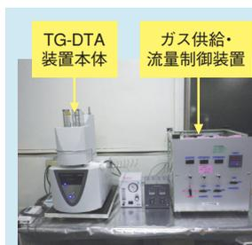
写真1 操業環境対応型TG-DTA試験装置
