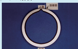
腐食損傷管の断面観察
