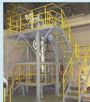
写真2 循環流動層燃焼試験装置
