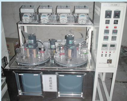
写真1 メタン発酵試験装置
