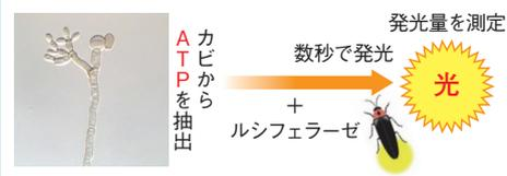
図1 ATP法の測定原理
