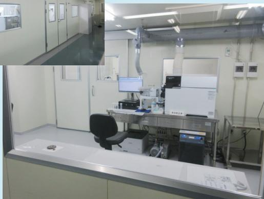
図2 誘導結合プラズマ質量分析装置(ICP-MS)
