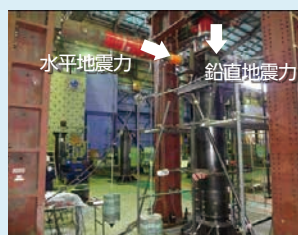
図1 鋼管杭の耐震試験
