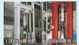
図2 1MN・500kN 疲労アクチュエーター
