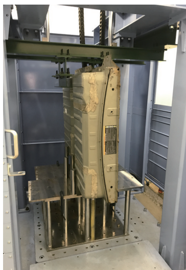
図1 大開口落錘試験機 (左: 全体、右: 試験体設置スペース)
